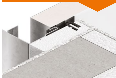
System ciepłego montażu
